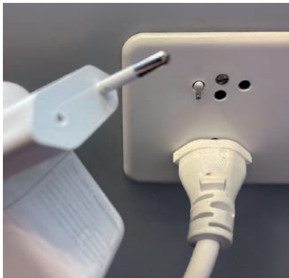
Difetto molto pericoloso (la spina con connettore rotto è falsificata).
